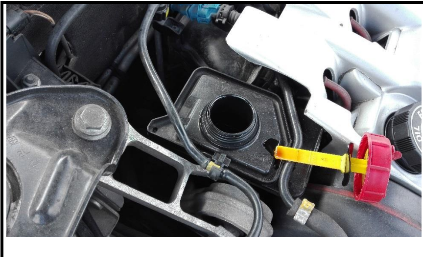
Figura 3 – Reservatório do óleo dos travões é um dos componentes a verificar
